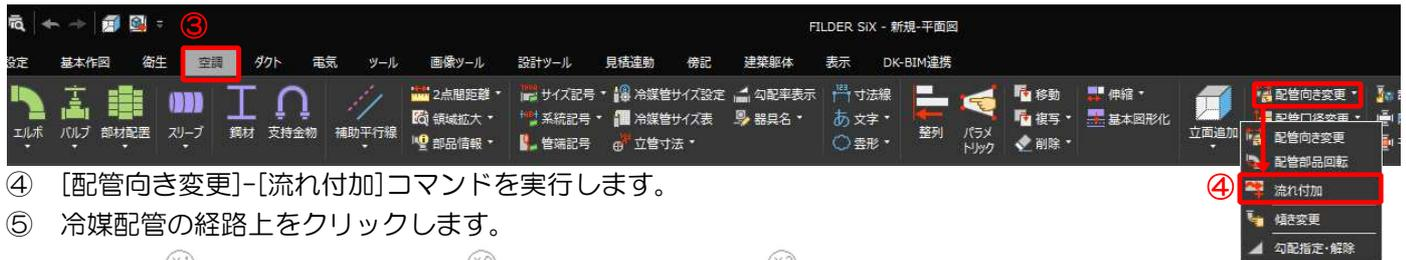
④ [配管向き変更]-[流れ付加]コマンドを実行します。
