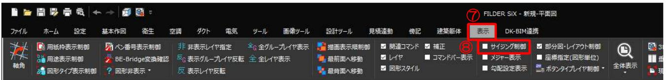
⑧ 「サイジング制御」のチェックを外します。(サイジング制御の解除)
