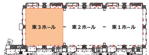
アンカーボルト打設禁止エリア
